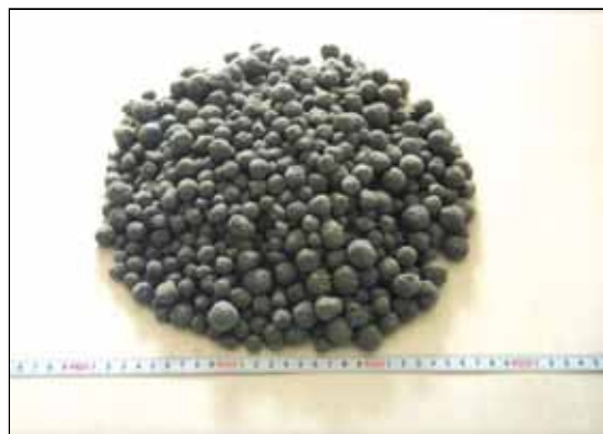
Hiビーズ (護岸工事用海砂代替材)
