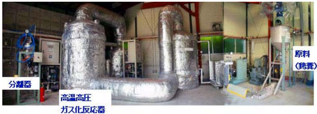
試験装置配管機器系統 外観 (高温高圧ガス化試験装置建屋内)
