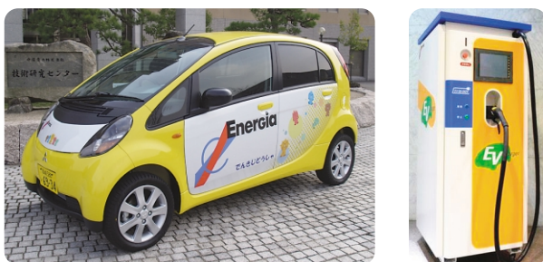
▲ 高性能なリチウムイオン電池を搭載した電気自動車「i-MiEV(アイ・ミーブ)」と急速充電器
