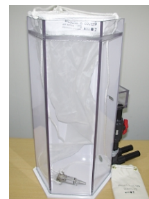
幼生捕集用プランクトンネットおよび幼生捕集・ろ過ハウジング
