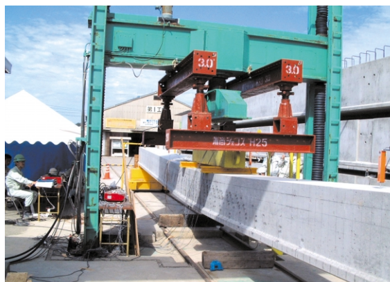
▲ 石炭灰混入のコンクリート桁の曲げ載荷試験
