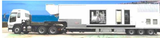
非常用炉心冷却系等を起動できる容量をもったガスタービン発電機車を配備
